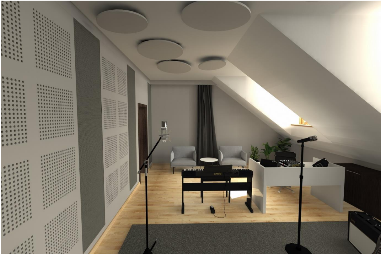
Rys.16. Wizualizacja pomieszczenia (panele sufitowe rozpraszające dźwięk - OPCJA).
